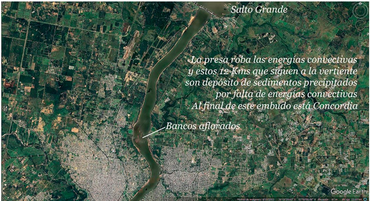
La presa de Salto Grande a pocos kilómetros al Norte de Concordia **es la responsable** del robo de las energías convectivas, cuya alta capacidad para transportar sedimentos evitaría estas deposiciones en los tramos que median entre la vertiente y Concordia,
