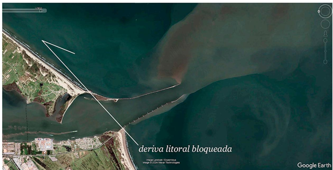
Las imágenes muestran la salida tributaria de la gran "laguna de los patos". Esa salida no descubre su acople termodinámico a la deriva litoral a través de la curva en el cordón litoral de borde cuspidado, que en este caso ha sido destruída, para sólo mostrar esa prepotencia en las turbulencias de esa salida forzada; generando convexión externa y robo de playas atlánticas.
